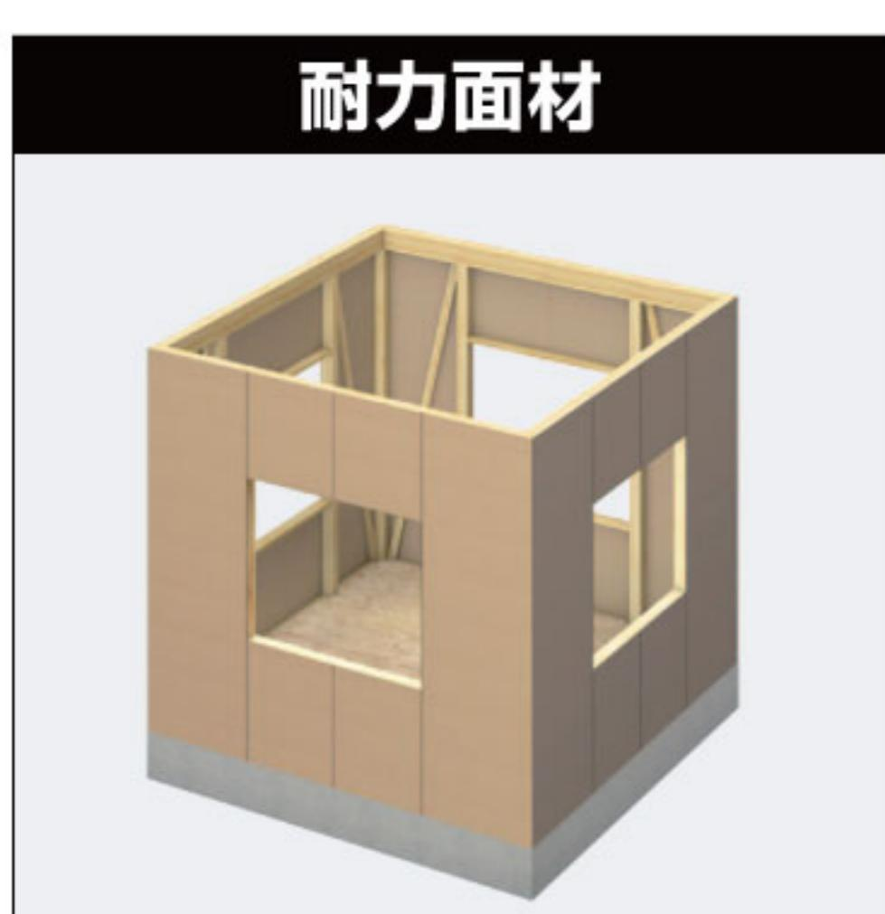
構造用面材を壁全体に張ることにより、荷重を壁面全体へ分散します。また、耐力壁をバランス良く配置することで荷重を建物全体へ分散します。
