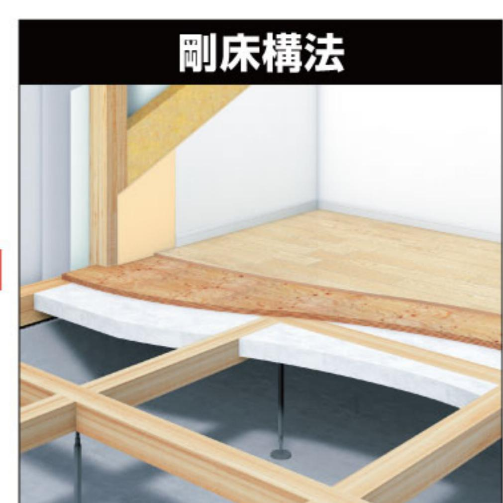
24mmの構造用合板を土台や梁に直接留めつけて、床全体を一体化します。一般的な根太工法に比べ、横からの力に対する強度が2倍になり、地震の横揺れにも効果を発揮します。また、2階の床には厚さ12.5mmの硬質石膏ボードを敷き詰めて防音対策を施しています。
